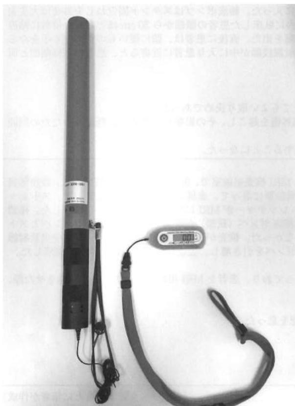
図4 金属探知器と強磁場警報器
